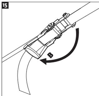
Une fois que la sangle est relâchée, enlevez la sangle du tendeur à cliquet, contrôlez la sangle pour y détecter d'éventuelles détériorations ou abrasions. Veillez à ce que la sangle soit propre et sèche, enroulez-la et mettez-la dans le sac prévu à cet effet.
