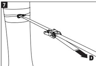
Hale la banda a través del eje hasta que la banda esté tensa (a saber, la banda no está floja) ("D" en la Imagen 7)
