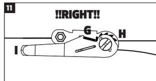
Tip: Der geschlossene Hebel (Punkt "I" im BILD 11) ist ein guter Hinweis, dass der Bolzen eingerastet und die Ratsche somit gesichert und geschlossen ist.
