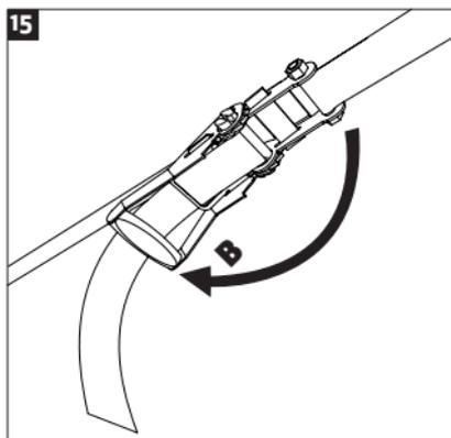
**IMPORTANTE!** La fascia è sotto tensione e, se non viene smontata con cura, potrebbero verificarsi lesioni e/o morte.
