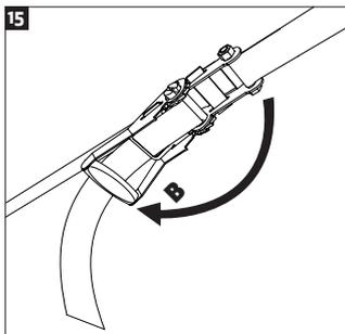
Uma vez que a banda está liberado, separar a banda da catraca, inspecionar a banda para escoriações e danos, certifique-se a banda está limpa e seca, e roll-up da banda e colocá-lo em seu saco de armazenamento.
