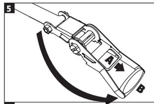
Per ridurre il rischio di lesioni gravi e/o morte, installare il cricchetto con la levetta verso il basso, come mostrato nella Figura 4. Rilasciare il cricchetto (tirare la levetta all'interno del cricchetto contrassegnato "A" nella Figura 5) e aprire la leva principale ("B" nella Figura 5). Far passare la fascia attraverso la fessura nell'asse ("C" in Figura 6).
