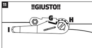
Appena la fascia raggiunge la tensione desiderata, controllare il cricchetto per assicurarsi che il bullone ("G" nelle Figure 10 e 11) poggi perfettamente nell'ingranaggio ("H" nelle Figure 10 e 11) e riportare la levetta ad una posizione orizzontale parallela alla fascia ("I" nella Figura 11).
