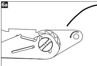
Zusätzliche Informationen zur Benutzung der Ratschen der GIBBON Surfer Line X13 und der GIBBON Andy Lewis Trickline: Bitte wie in Darstellung 6a illustriert die Slackline von oben in die auf dem Kopf liegende Ratsche einfädeln (Hebel zeigt nach unten).
